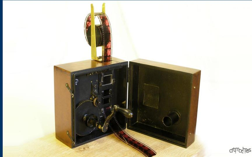
Le " petit moulin " est une véritable usine à image autonome, réunissant dans un même appareil de petite dimension et pesant moins de 5 kg des fonctions de :
